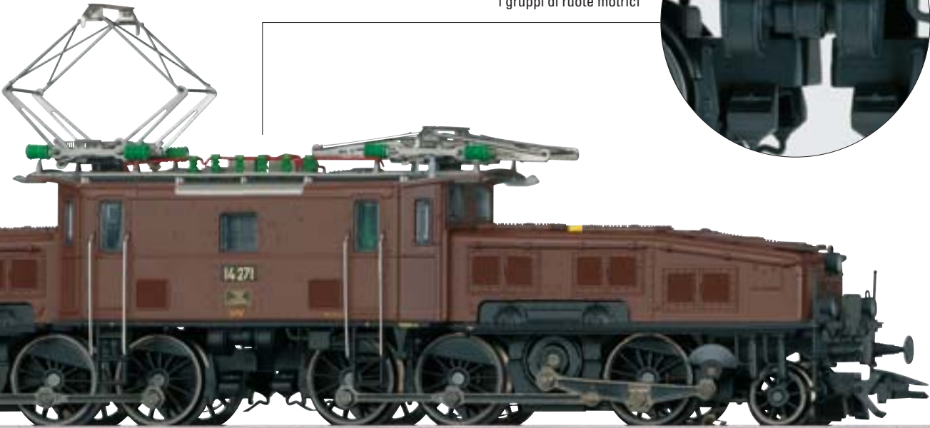
Nuovo impianto di spargimento sabbia tra i gruppi di ruote motrici
