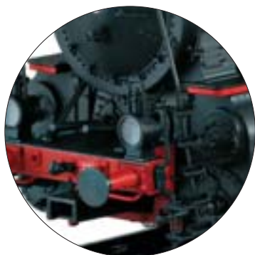
Fanali liberi intorno e scalette di salita in filigrana riportate
