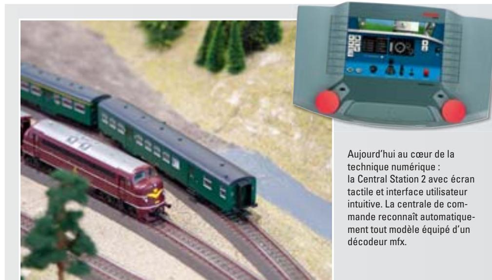
Aujourd'hui au cœur de la technique numérique : la Central Station 2 avec écran tactile et interface utilisateur intuitive. La centrale de commande reconnaît automatiquement tout modèle équipé d'un décodeur mfx.
