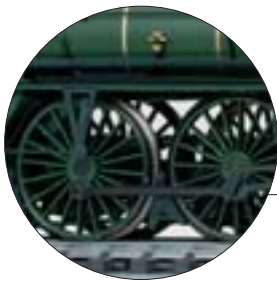
Ruedas motrices gigantes - Diámetro en el original: 2,20 m
