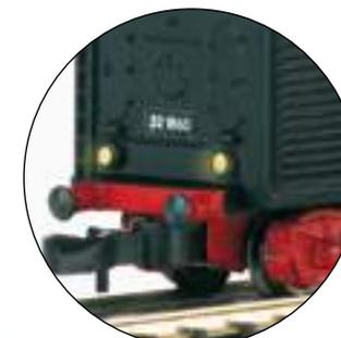
Éclairage frontal fonctionnel sur le tender, inversion en fonction du sens de marche
