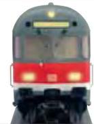
Bei schiebender Lokomotive (Steuerwagen voraus) leuchtet am Steuerwagen ein weißes Dreilicht-Spitzensignal.
