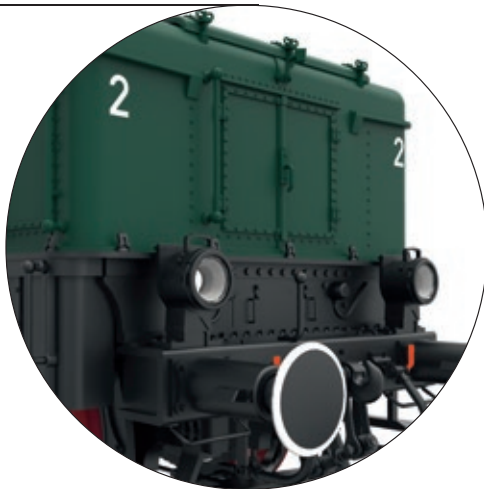
Das besondere Gesicht der E 60 13: kleine elektrische DRB-Laternen
