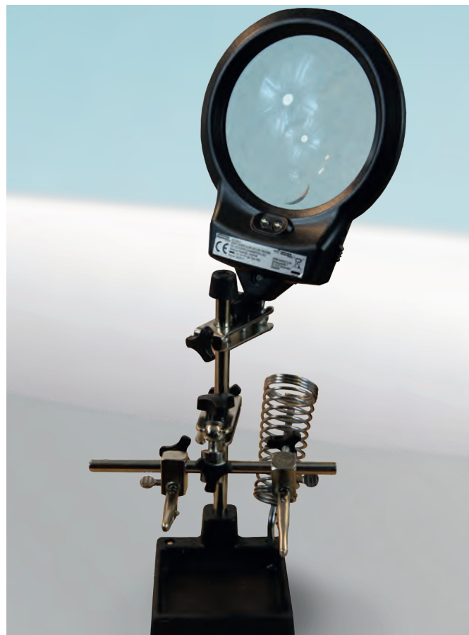
Een loep helpt het zicht en de "derde hand" is zeer nuttig: zij houdt het printplaatje vast, zodat het tijdens het solderen stabiel is.
