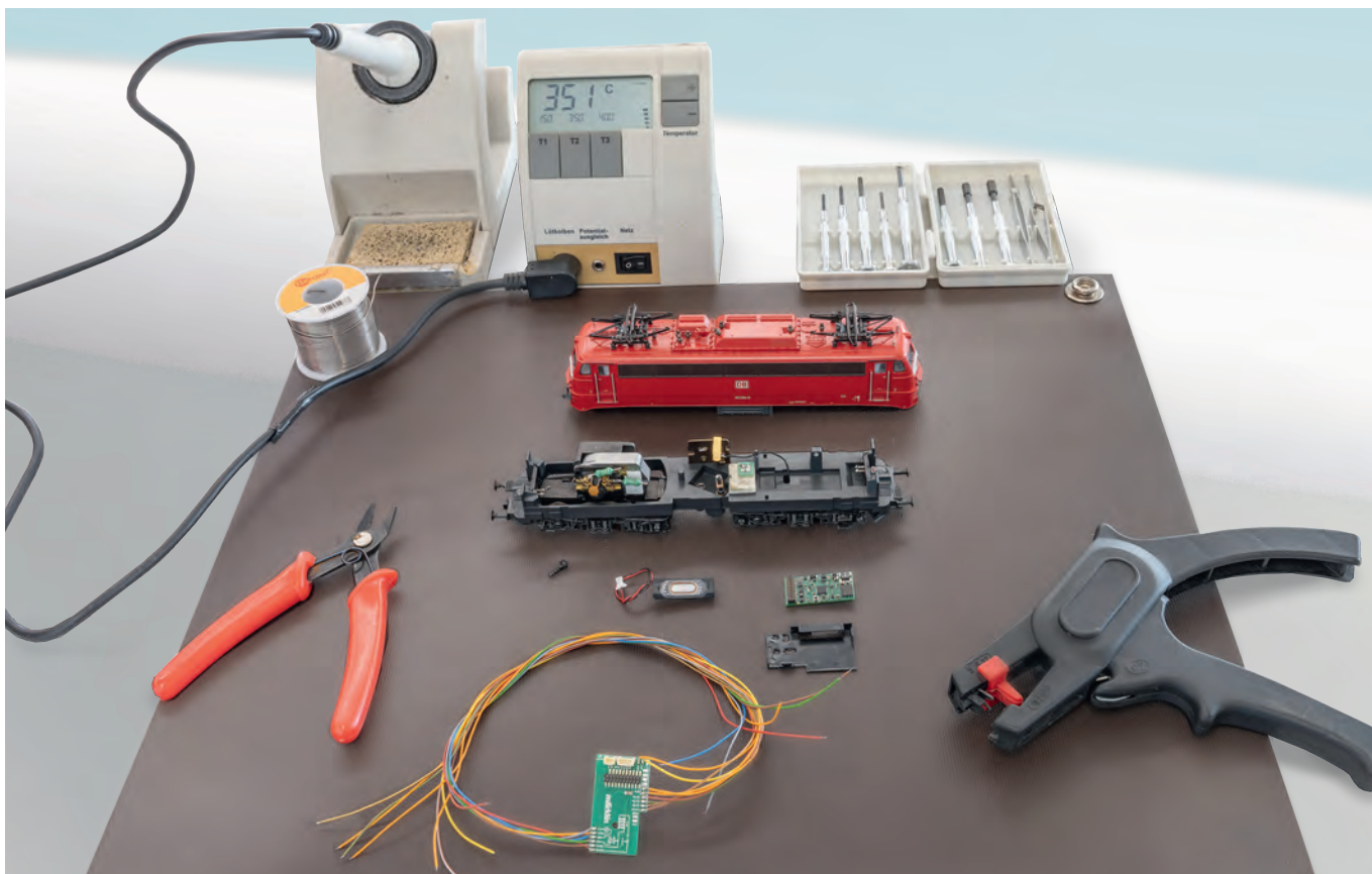
Geschikt voor beginners: speciaal gereedschap is voor de ombouw niet nodig, wel verschillende schroevendraaiers, striptang, krimp-tang en natuurlijk een regelbaar soldeerstation. Als materiaal hebben we soldeertin, krimp-moffen en eventueel draad nodig.
