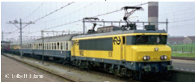
**Modèle réel :** Locomotive électrique série 1600 des chemins de fer néerlandais (NS). Numéro d'immatriculation 1652.
