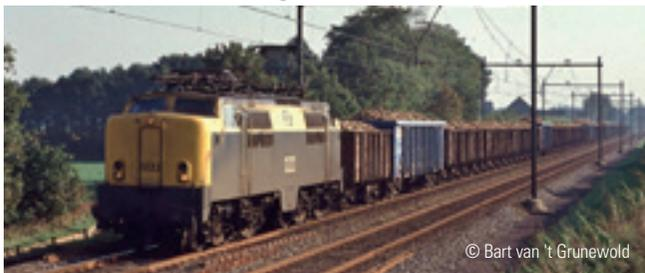
**Modèles réels :** 3 wagons tombereaux à bords hauts type Eo des chemins de fer néerlandais (NS). Avec respectivement deux double portes latérales. Etat de service : fin des années 1980.
