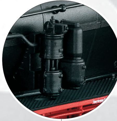
Enkelvoudige toevoer pomp type Knorr op de linkeromloop
