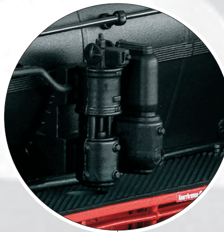
Einfache Speisepumpe Bauart Knorr auf dem linken Umlauf
