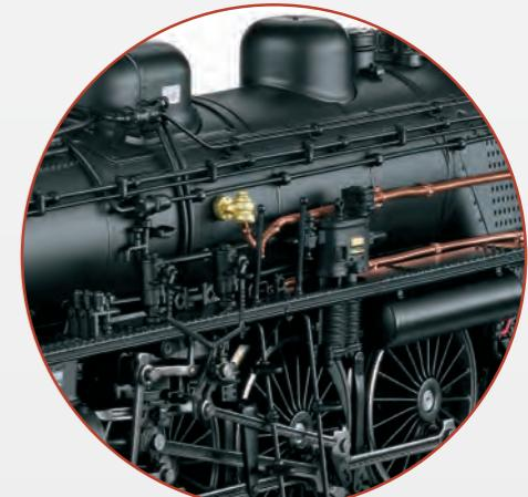
Sur le côté gauche de la locomotive, à côté des conduites en cuivre, se trouvent également la pompe à air, deux pompes à huile et le distributeur des conduites de graissage.
