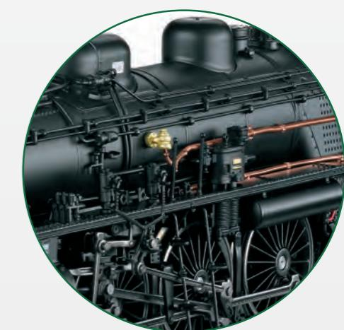
Sur le côté gauche de la locomotive, à côté des conduites en cuivre, se trouvent également la pompe à air, deux pompes à huile et le distributeur des conduites de graisse.
