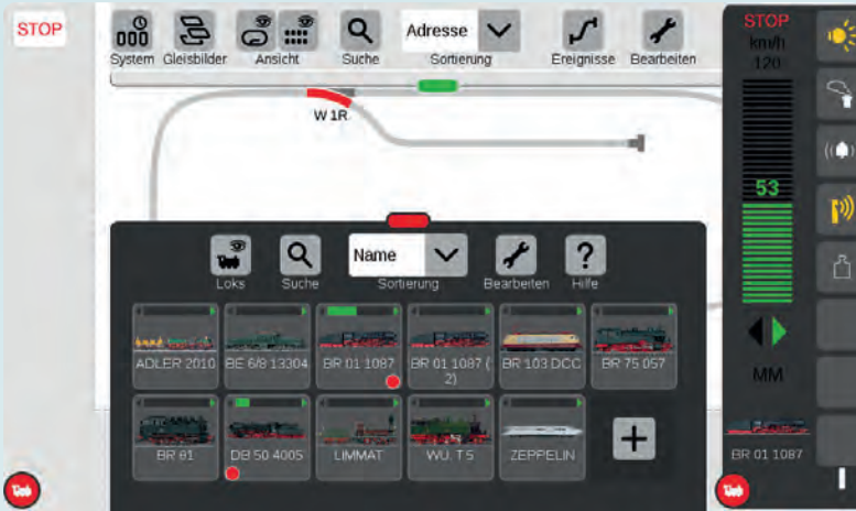
Synchrone weergave 1: Op de CS3 is rechts in de rijregelaar de actuele 01 1087 en haar rijstatus te zien. Alle overige verbonden besturingsapparaten, zoals de MS2, geven deze actuele waarden aan zodra de loc wordt gekozen.
