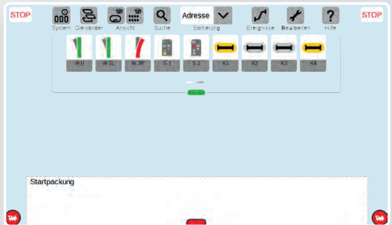
Gelijke lijst 1: De Central Station 3 stelt haar lijst van magneetartikelen beschikbaar aan alle besturingsapparaten. Dit is een voordeel voor de Mobile Station, die een lijst in deze vorm zelfstandig niet kan weergeven.
