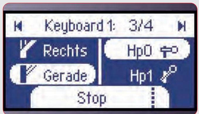
Met de toets voor magneetartikelen wordt het toetsenbord voor het schakelen van digitale artikelen gebruikt. Met de bovenste functie-toetsen aan beide kanten wordt tussen de toetsenborden omgewisseld.
