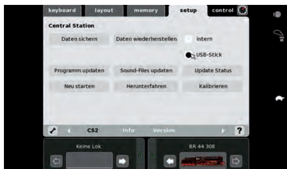
Back-up maken in het setup-menu van de Central Station 2: “USB stick” als bestemming kiezen en “Gegevens opslaan” aantippen.
