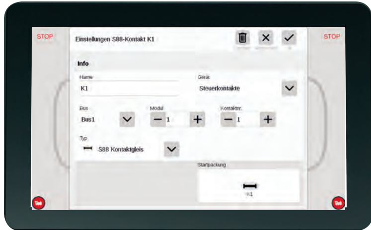
De instellingen van het s88-contact K1 zijn duidelijk: Het is het eerste contact van de eerste terugmeldmodule die is aangesloten aan bus 1.
