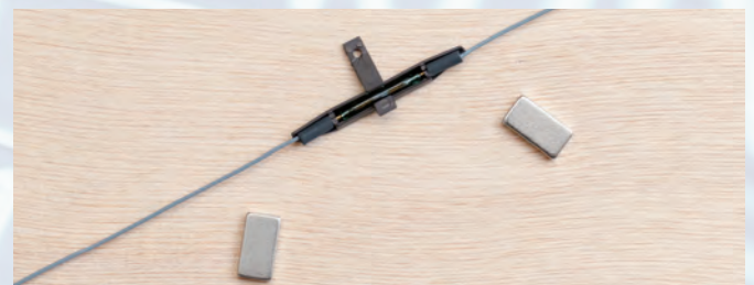
Een reedschakelaar en twee schakelmagneten: Wanneer beide op de rijstraat elkaar ontmoeten, wordt een schakelimpuls geactiveerd.
