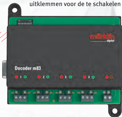
De m83-decoder: Linksboven de DIP-schakelaars voor de instelling van de adressen, onder de aansluitklemmen voor de te schakelen wissels.
