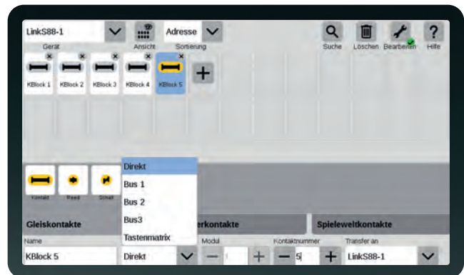
Verbinding moet overeenstemmen: bij de s88-contacten de juiste aansluiting kiezen voor apparaat, bus, module en contactnummer.
