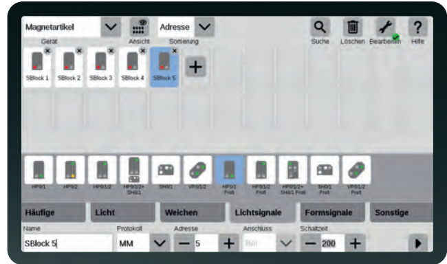
Namen zorgen voor duidelijkheid: een correcte adressering van de seinen is nodig, een duidelijke aanduiding helpt bij de besturing.
