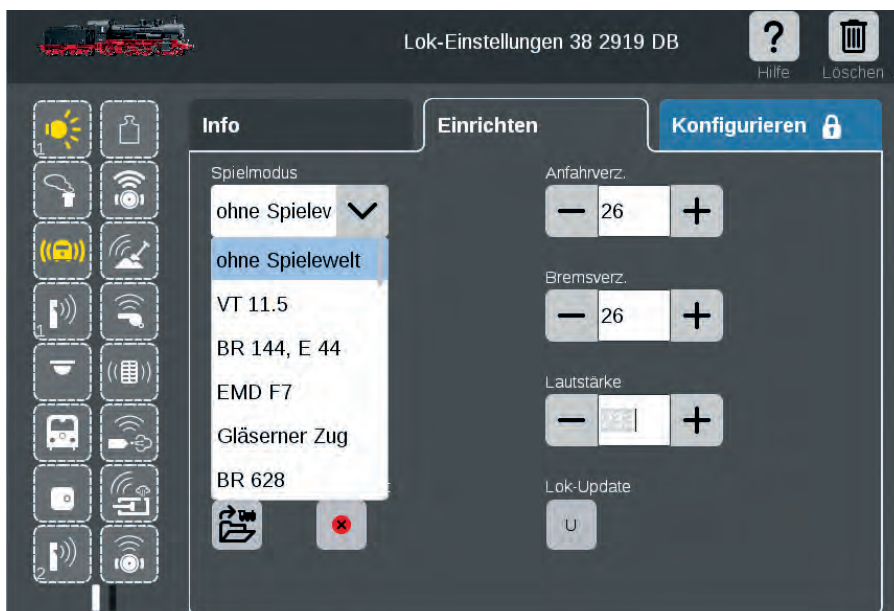
In de locinstellingen kunt u op de tab “Instellen” onder “Speelmodus” de weergave van de cabine kiezen bij de modellen zonder mfx+-Decoder met een achteraf ingebouwde decoder.
