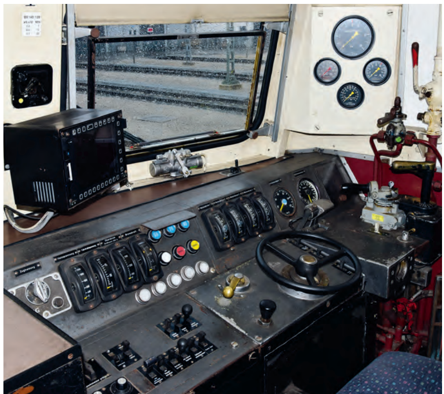
E10-cockpit van het voorbeeld: de DB-eeenhedscabine van de serie 110/139. In tegenstelling tot de serie 140 is er hier ook een elektrische rem.
