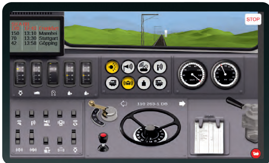
Tijdens de rit is de veiligheidsrijschakeling actief. De waarschuwing verschijnt linksboven en de knop wordt rood. Als hij niet wordt ingedrukt, blijft de loc staan.
