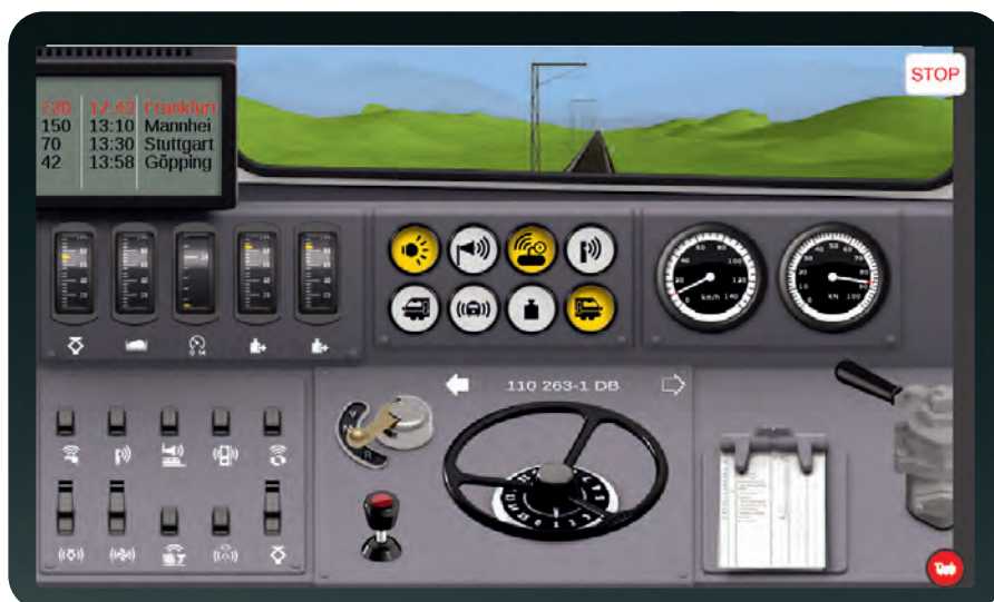
Rangeren: de rijrichtingsschakelaar in het midden staat op "R". Er wordt niet sneller dan 25 km/u gereden, dat stemt overeen met rijstand 1 tot 2 bij de speelwereld.
