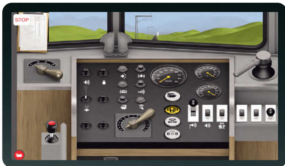
Net als bij het voorbeeld: de deuren worden geschakeld met de tweede knop onder de tacho, de stationsaankondiging met de hendel rechtsonder. De remmen rechtsboven zijn nog aangetrokken.
