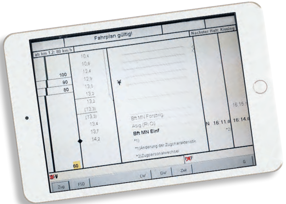
De dienstregelingsfiche is bij de huidige voertuigen elektronisch en kan gemakkelijk worden bijgewerkt.
