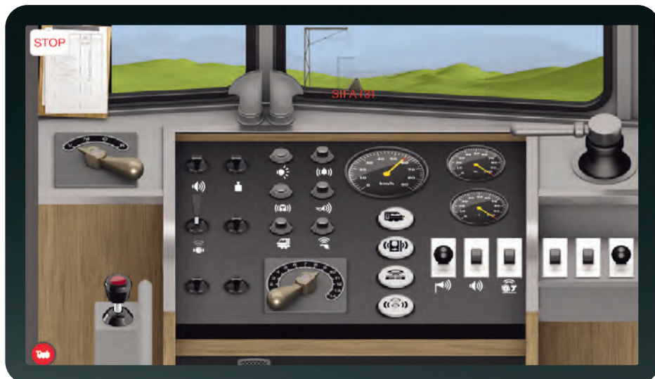
Tijdens de rit moet ten laatste als de "SiFa"-aanduiding op de voorruit verschijnt, de oplichtende "SiFa"-knop of een draairegelaar worden gebruikt, anders blijft de loc staan.
